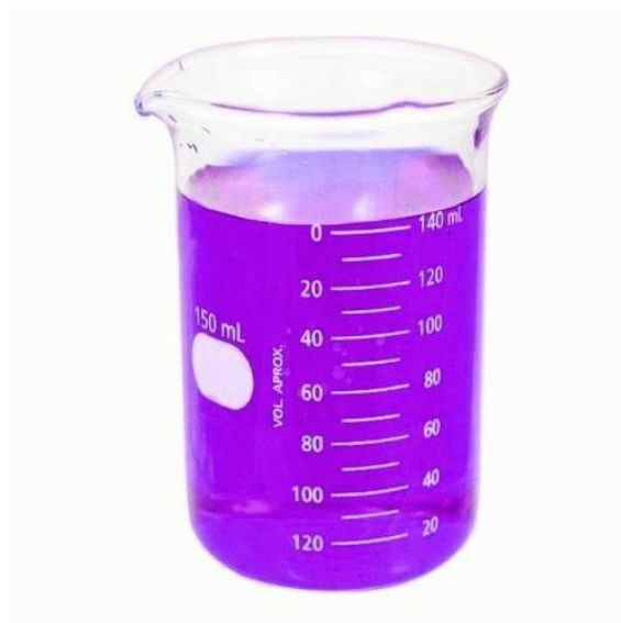
Figura 3: Características de cromo trivalente com coloração violeta evidenciando ausência de Cloretos.
