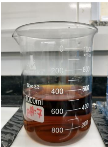
Figura 5: característica no aspecto da solução onde o ânion de dicromato de sódio é maior em meio ácido.
