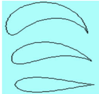
Figura 24 - Perfil de uma asa de avião (Aerofólio de Joukowski)
