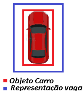
Figura 17 – Representação da lógica para detectar se existe carro na vaga.
