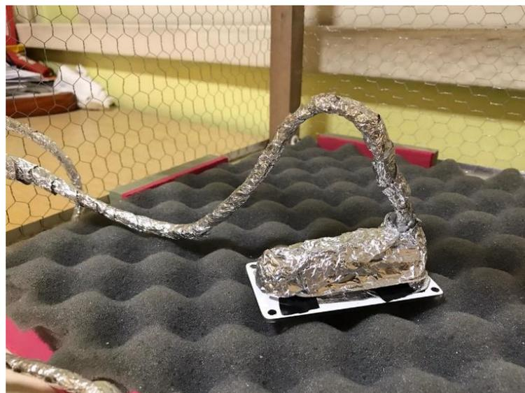
Figura 28: Blindagem do captador magnético.
