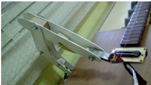
Figura 35: Dispositivo Palhetador.
