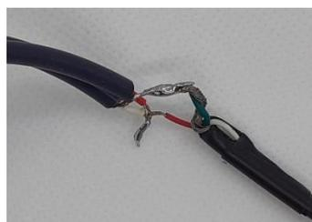
Figura 25: Junção soldada: cabos do conector soldado aos cabos do captador magnético e malhas das blindagens soldadas entre si.
