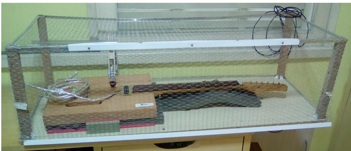
Figura 22: Gaiola de Faraday montada para o ensaio com um corpo de prova posicionado.
