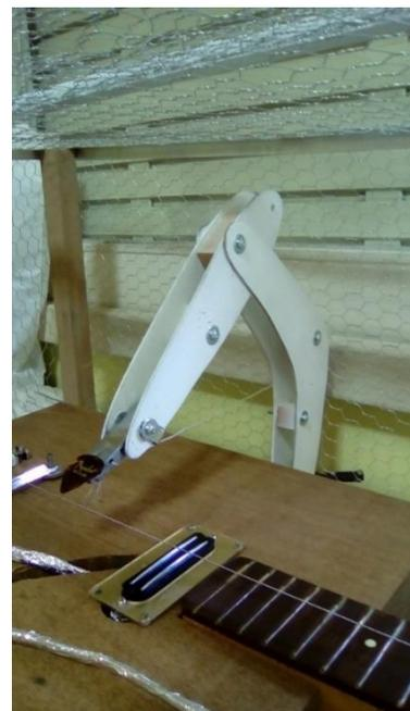
guitarra elementar é captado pelo captador magnético. O captador magnético transmite o sinal de som ao computador através da placa de som externa ligada à porta *USB*. O programa *Raven Lite* decodifica o sinal transformando-o em dados, e salva o arquivo de som no formato *.aif*. O programa *Raven Lite* permite a obtenção de dados e apresenta os resultados na forma de gráficos.
