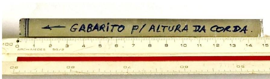
Figura 33: Gabarito para verificação da altura da corda em relação ao captador.
