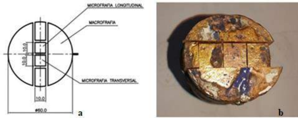
Figura 34a e 34b - Desenho esquemático e figura dos cortes para macro e microestrutura.
