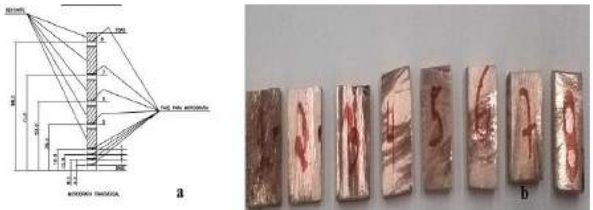
Figura 36 – (a) Desenho esquemático dos cortes. (b) Amostras para metalografia transversal.
