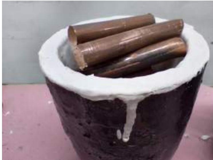
Figura 21- Cadinho com a liga UNS C19400 cortada em pequenas barras.
