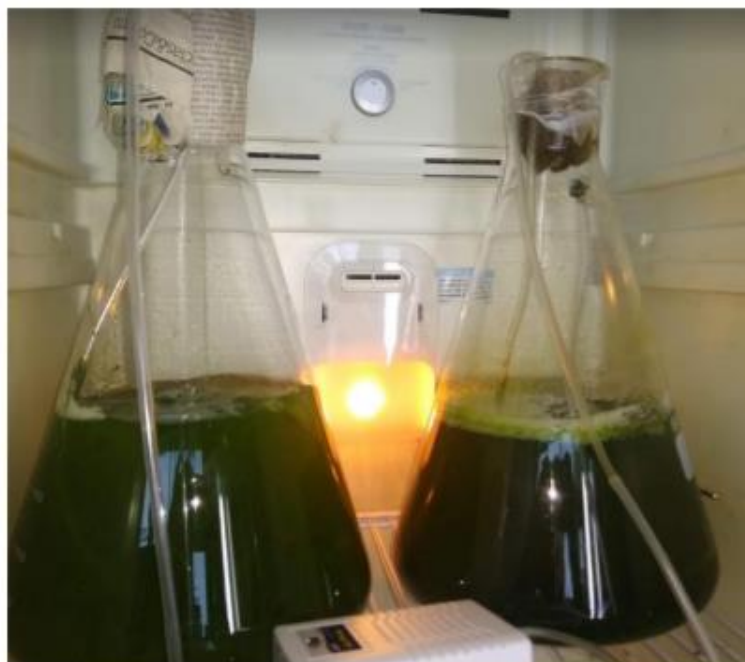
Figura 13. Cultivo de Chlorella vulgaris e Scenedesmus acuminatus em pH 7 e 8 respectivamente da esquerda para direita, capacidade de cultivo de 5 L.
