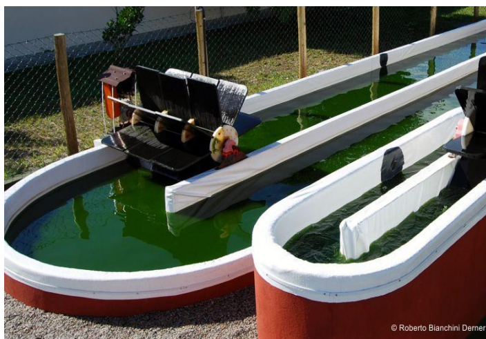
Figura 2: Tanque de sistema aberto, com condições naturais de iluminação e temperatura solar.
