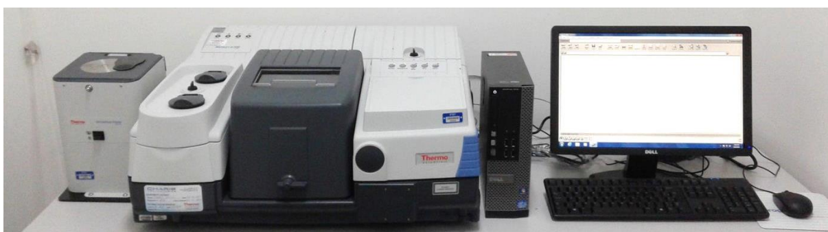
Figura 9. Espectrofotômetro Nicolet 6700 FT-IR utilizado para análise de resultados.
