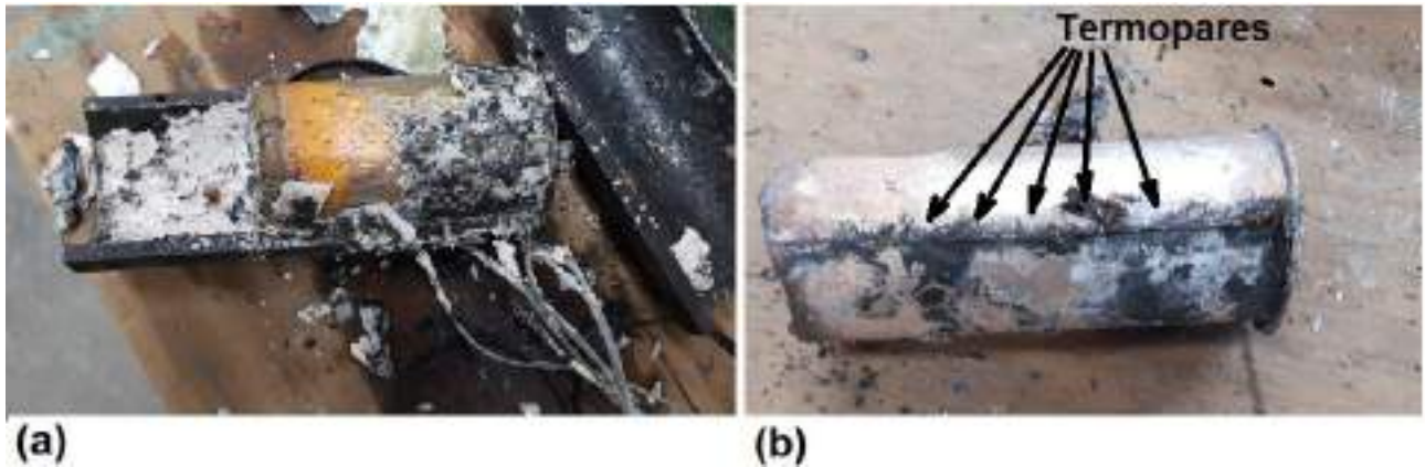
Figura 27 - Lingote sendo retirado da lingoteira (a); Tarugo de bronze com termopares (b).
