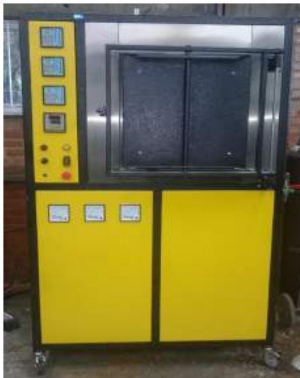
Figura 19 - Forno de fusão sobre atmosfera de argônio (NASCIMENTO, 2017)
