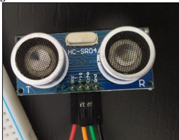
Figura 9. Módulo Sensor Ultrassônico HC-SR04.
