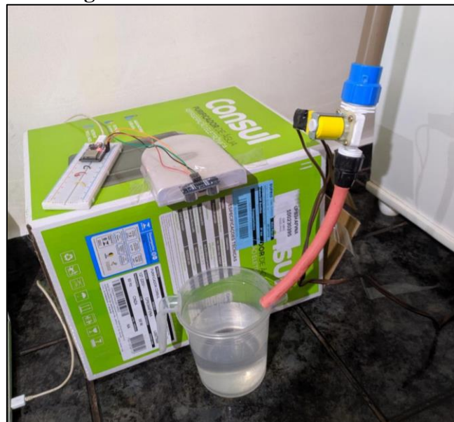
Figura 19. Teste de controle de nível.
