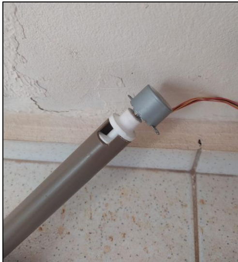
Figura 26. Cano com a rosca sem fim e o motor de passo.
