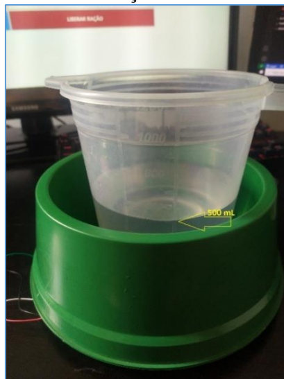
Figura 25. Calibração do sensor de carga.
