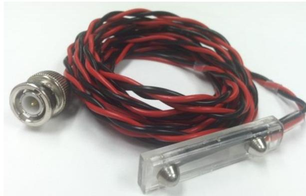
Figura 16 - Eletrodo reutilizável do tipo barra
