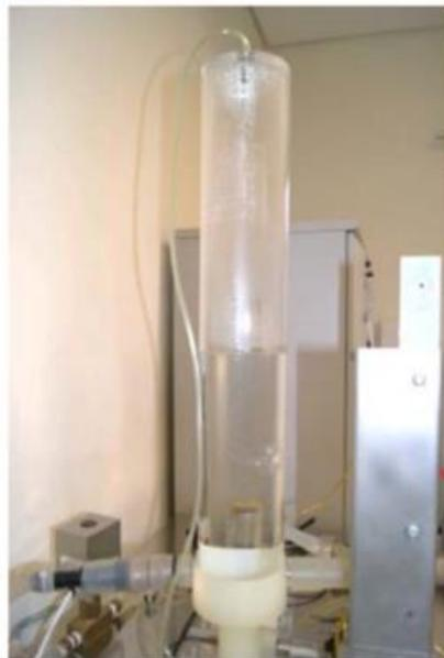
**Figura 24 - Reservatório fechado que representa o modelo Windkessel (FONSECA, 2013).**
