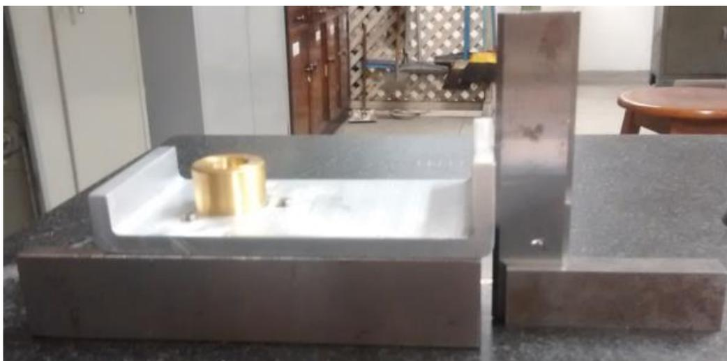
Figura 3.73: Suportes de Fixação dos Ímãs com Bucha de Latão e Verificação de Esquadro no Desempenho
