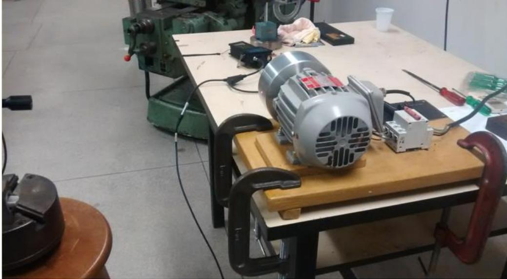
Figura 3.38: Dispositivo de campo, em vibra-stops e fixação com grampos fixos na bancada
