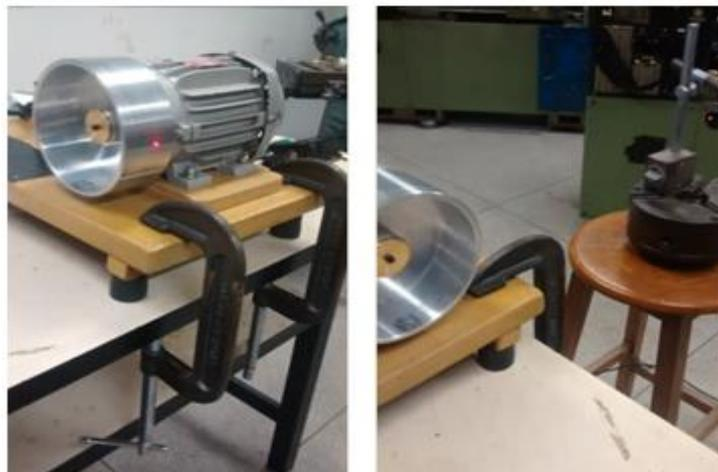
Figura 3.35: Dispositivo de campo, com vibra-stops e fixação com grampos fixos na bancada
