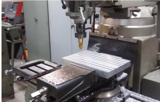
Figura 3.56: Fresamento da base de Alumínio
