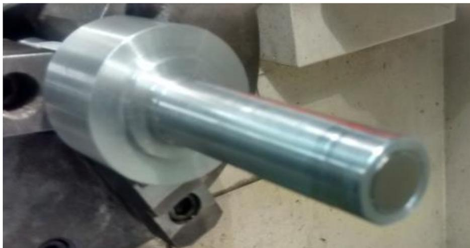
Figura 3.68: Eixo com Ímã de Neodímio Montado na Extremidade
