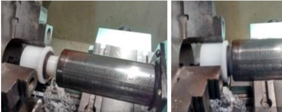
Figura 3.86: Montagem da Bucha de Poliacetal Menor no Torno Mecânico
