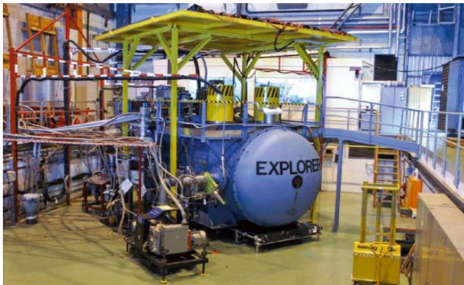
Figura 2.16: EXPLORE, Suíça - Detector de massa de ressonantes do tipo barra (3ª geração)
