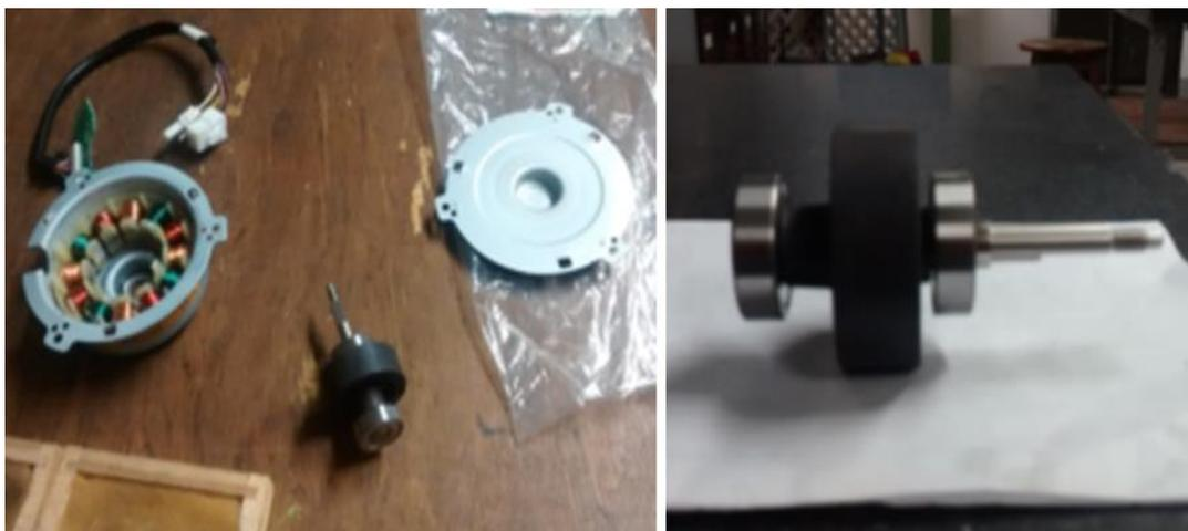
Figura 3.80: Desmontagem do motor para retirada do rotor
