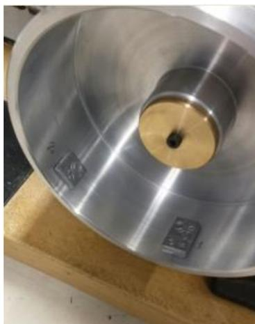
Figura 3.40: Uso de massores de chumbo adesivado para provocação do desbalanceamento e balanceamento do DSC (teste III)
