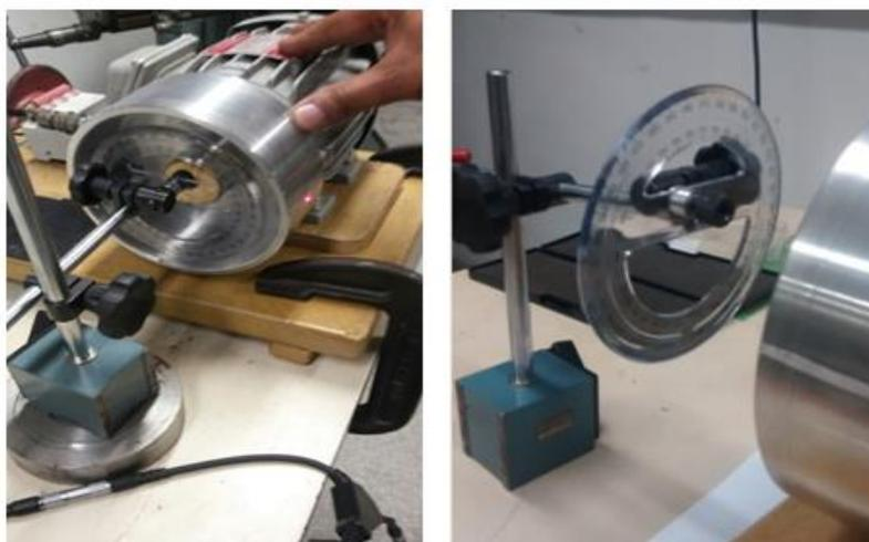
Figura 3.23: Transferidor 360° fixado em base m magnética
