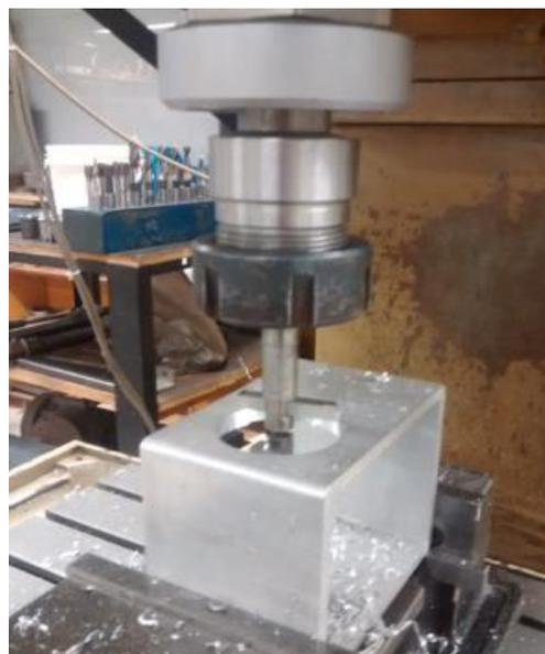
Figura 3.59: Mandrilhamento dos Suportes de Fixação dos Anéis de Neodímio
