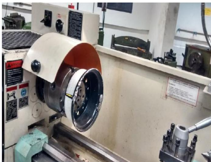
Figura 3.15: Roda montada no torno mecânico
