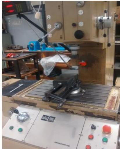
Figura 3.53: Alinhamento da Morsa na Fresadora Ferramenteira de Coordenadas
