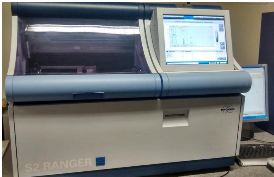
Figura 3.2: Equipamento de análise química por fluorescência de Raios-X - Bruker® S2 Ranger
