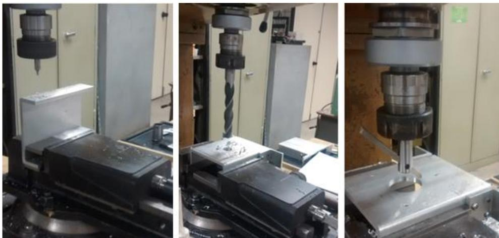
Figura 3.62: Furações e Mandrilhamento dos Suportes de Fixação dos Motores
