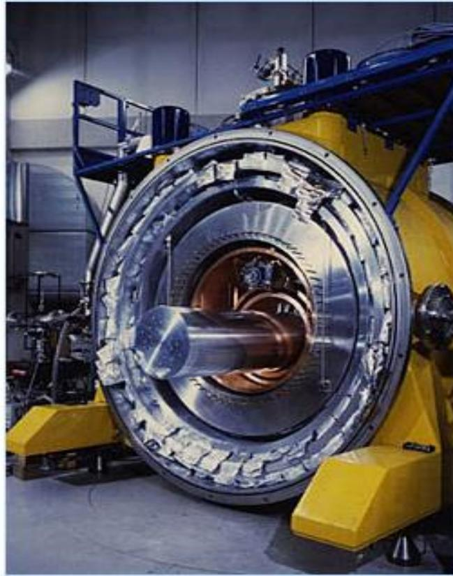
Figura 2.15: AURIGA, Itália - Detector de massa de ressonantes do tipo barra (3ª geração)
