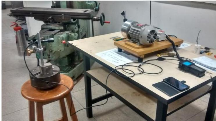
Figura 3.34: Dispositivo de campo, com vibra-stops em bancada reforçada
