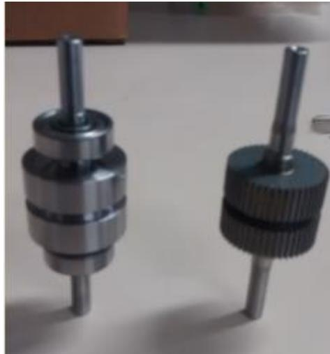
Figura 3.41: Eixo novo do motor pré-usinado (esquerda) e eixo original
