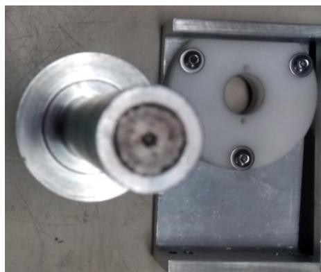
Figura 3.100: Falhas de sinterização e desgaste do imã de neodímio
