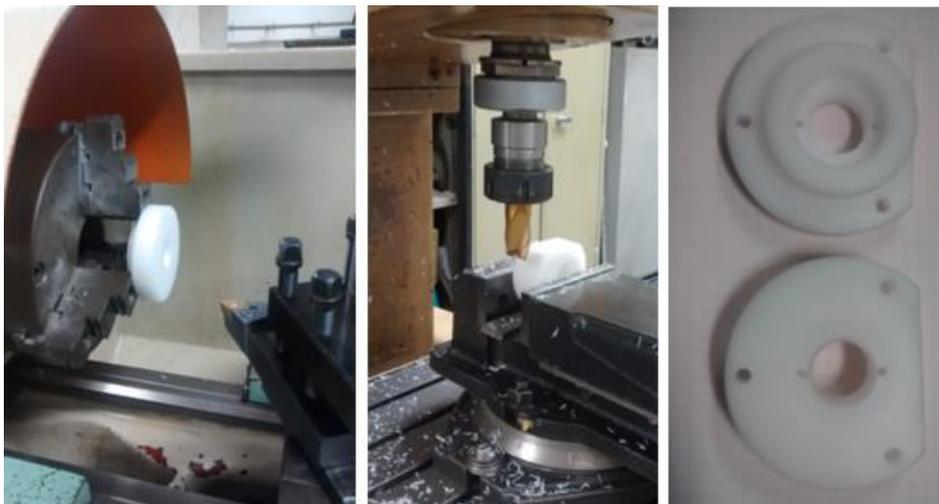
Figura 3.61: Torneamento, Fresamento e Buchas de Fixação dos Anéis de Neodímio
