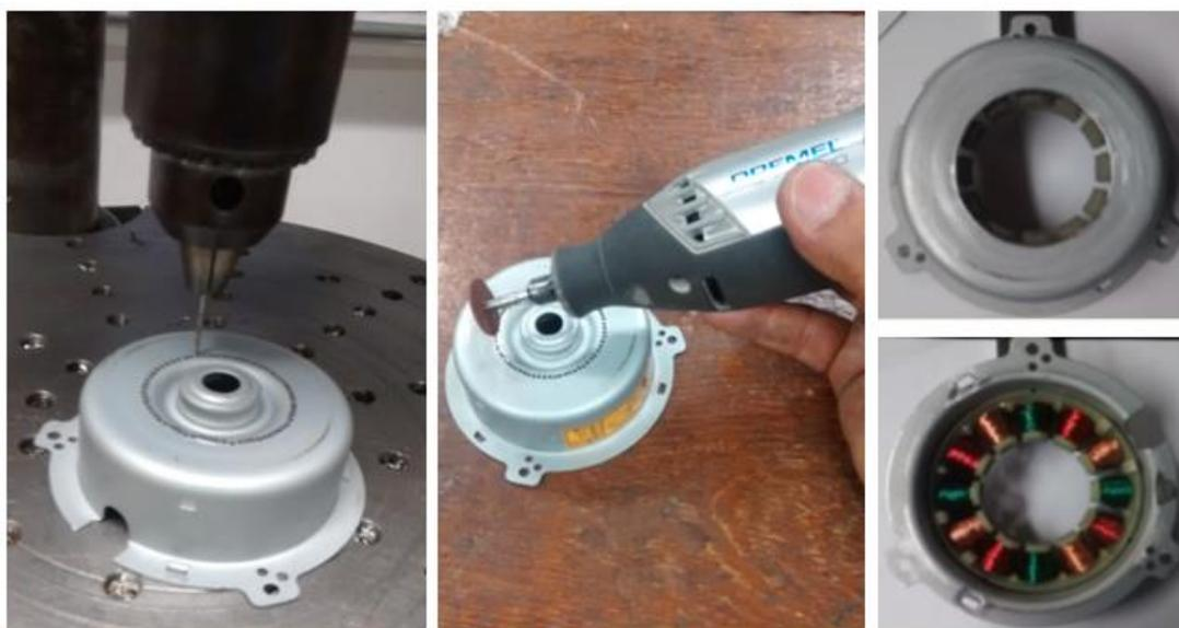
Figura 3.77: Usinagem de Abertura Parcial da Carcaça do Motor
