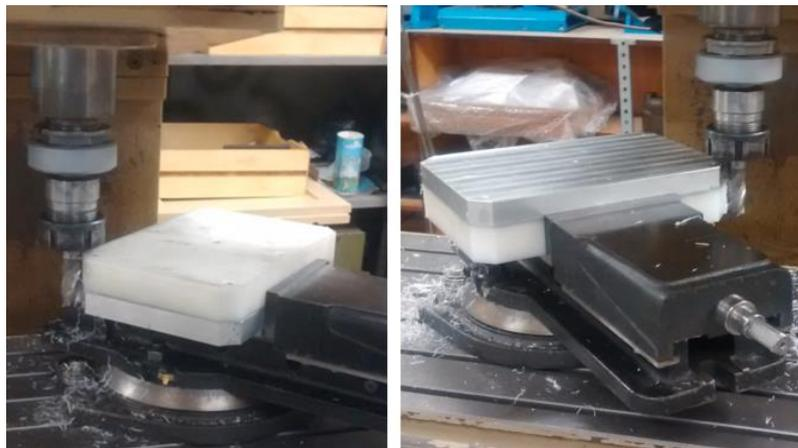
Figura 3.57: Usinagem dos chanfros das Bases
