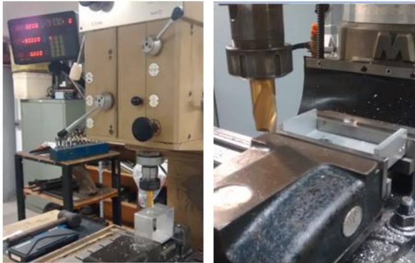
Figura 3.60: Fresamento dos Suportes dos Ímãs dos Mancais Magnéticos
