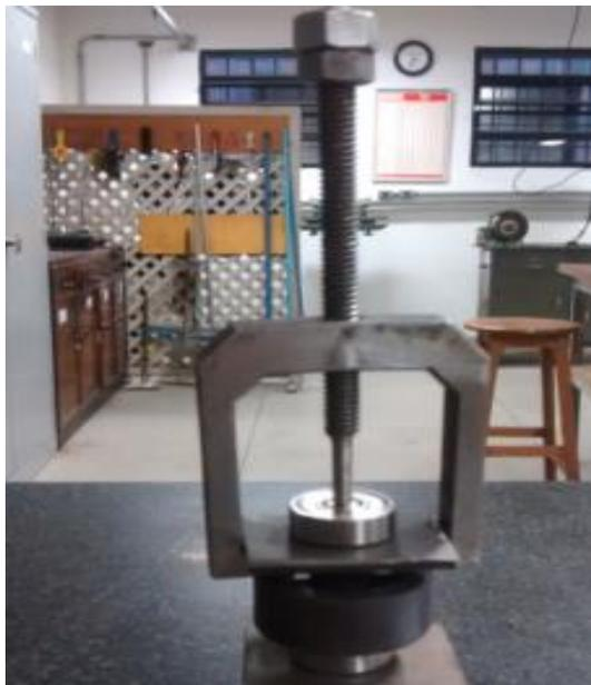
Figura 3.81: dispositivo para sacar rolamento
