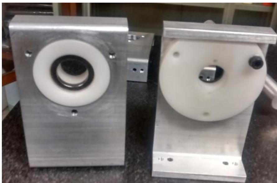
Figura 3.69: Suportes de Fixação do Anéis de Neodímio com Buchas e Pré-montados
