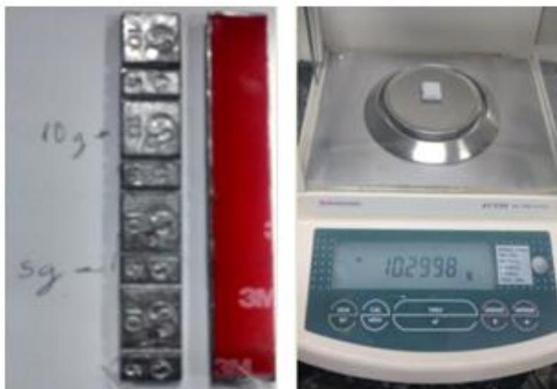
Figura 3.30: Massores de chumbo adesivados e medida da pré-carga em balança digital de precisão
