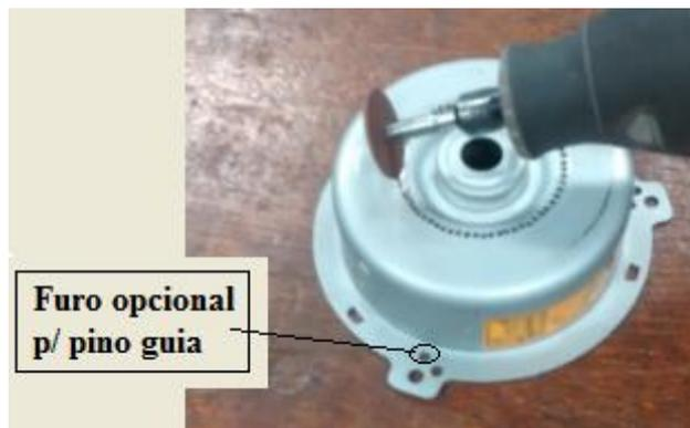
Figura 3.94: Furos para pinos-guias e centralização da interface estator/roto
