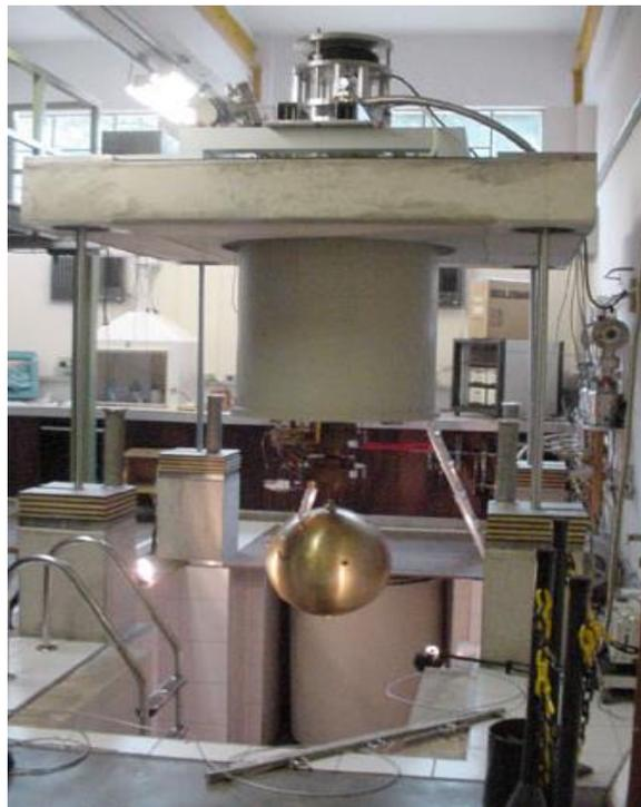
Figura 2.18: MÁRIO SCHENBERG, Brasil - Detector de massa de ressonante do tipo esférico (4ª geração).
