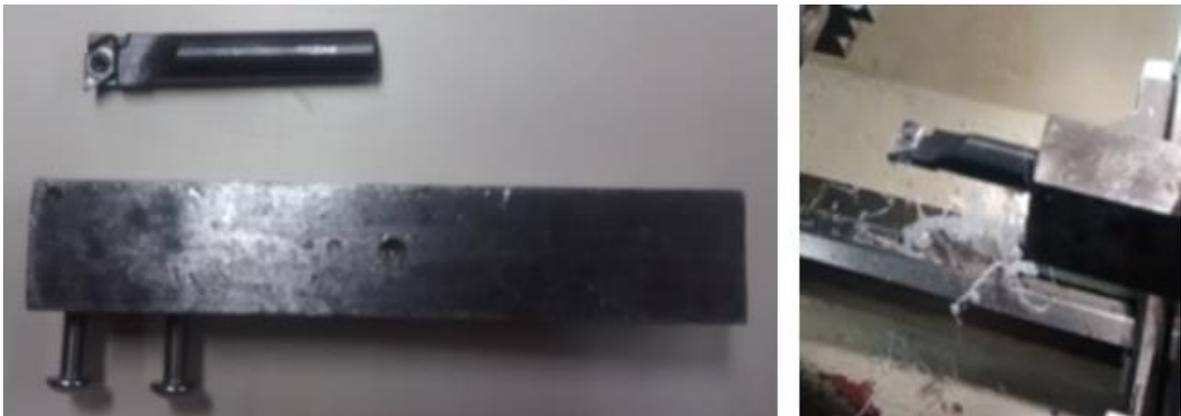
Figura 3.67: Dispositivo de fixação de Ferramenta para Torneamento do Alojamento do Ímã do Mancal
