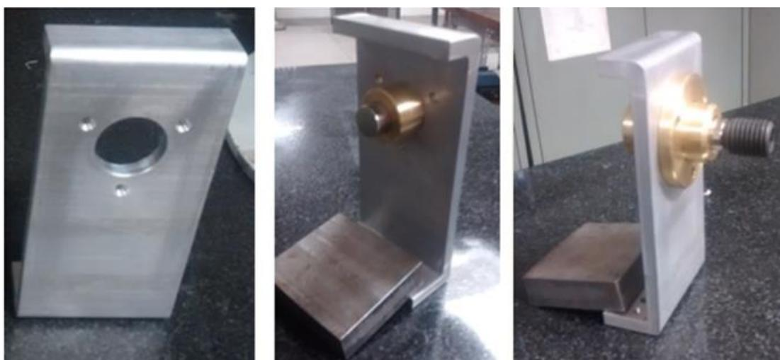
Figura 3.71: Suportes de Fixação dos Ímãs dos Mancais Magnéticos e Montagem das Buchas
