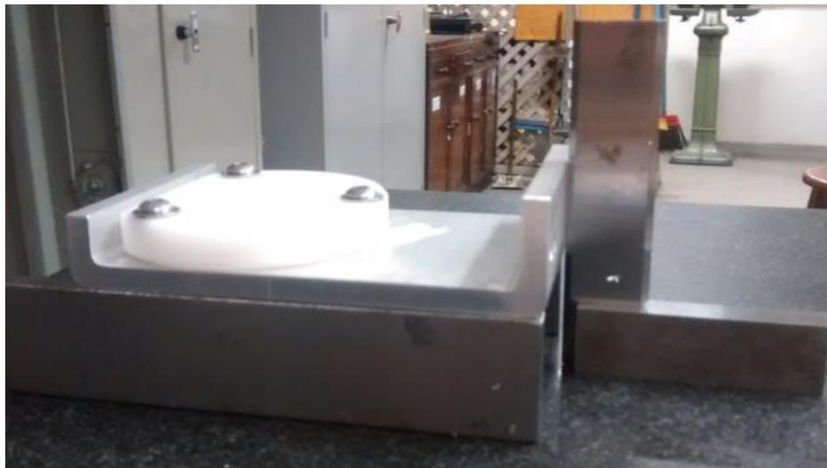
Figura 3.70: Suporte de Fixação do Anel de Neodímio com Bucha, Verificação de Esquadro em Mesa de Desempenho
