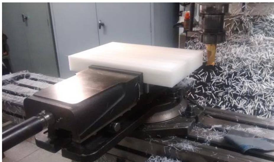
Figura 3.54: Fresamento e esquadreamento da base de poliacetal
