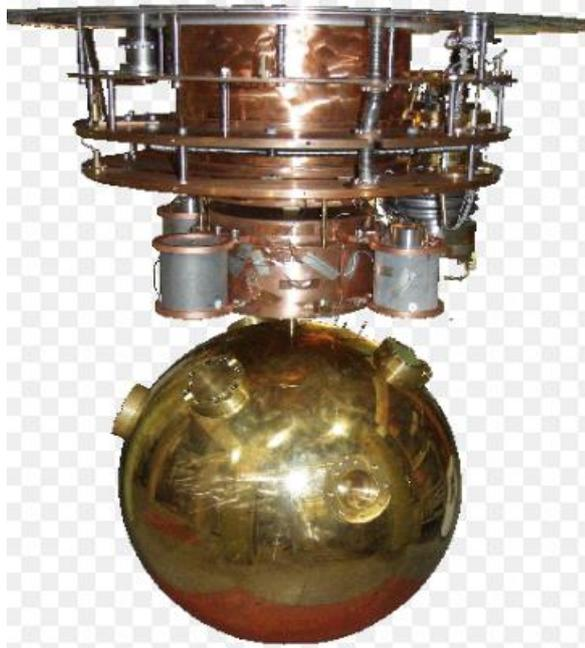
Figura 2.17: MINIGRAIL, Holanda - Detector de massa de ressonante do tipo esférico (4ª geração).
