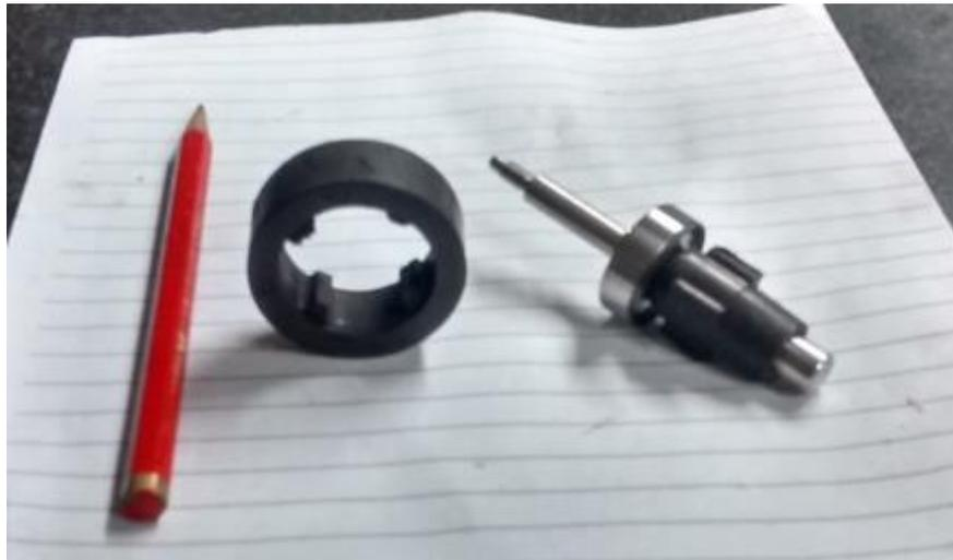
Figura 3.84: Finalização da retirada do “miolo” do rotor
