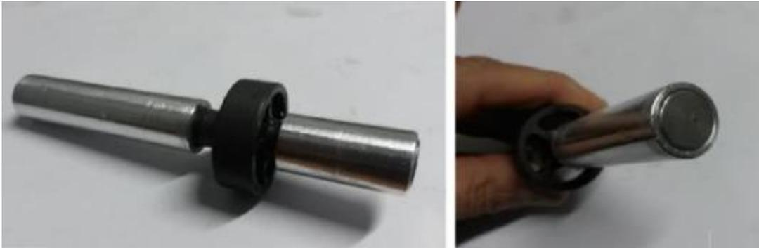
Figura 3.79: Detalhes do rotor montado e acoplamento do ímã de neodímio na extremidade do eixo
