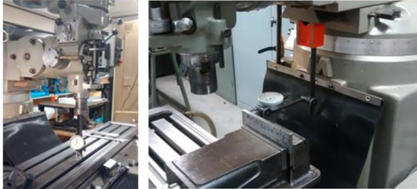
Figura 3.52: Alinhamentos do Cabeçote e Morsa da Fresadora Ferramenteira Analógica
