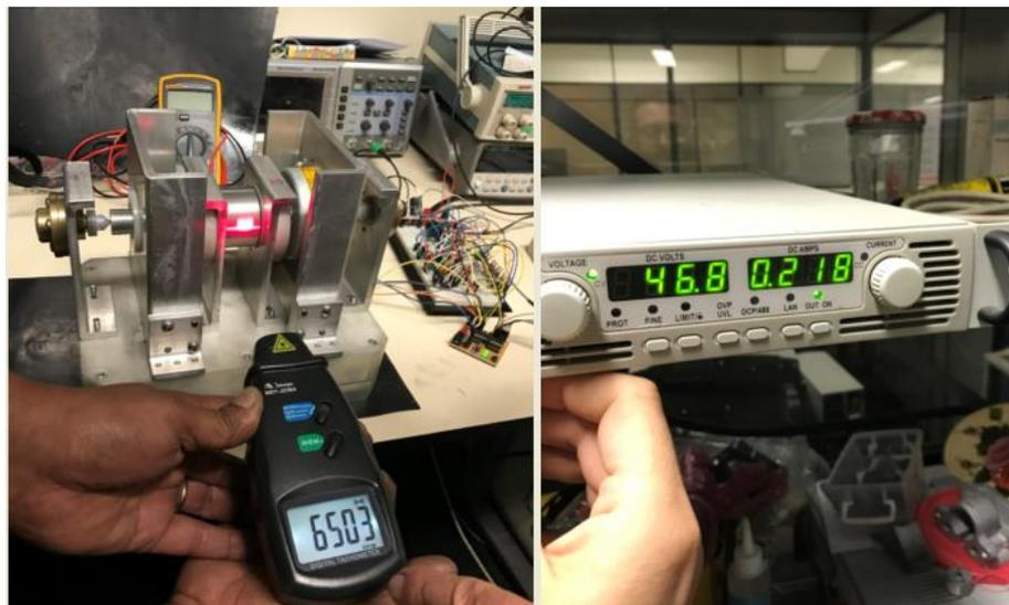
Figura 3.103: Velocidade de 6503 rpm e tensão de 46,8
