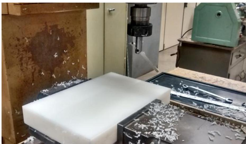
Figura 3.55: Fresamento da superfície da base de poliacetal com “bailarina”
