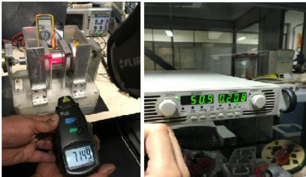
Figura 3.104: Velocidade de 7149 rpm e tensão de 50,9 V
