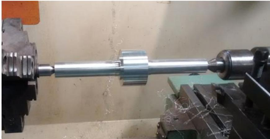
Figura 3.65: Torneamento do Eixo entre Pontas sem Arrastador (pressão/ atrito)
