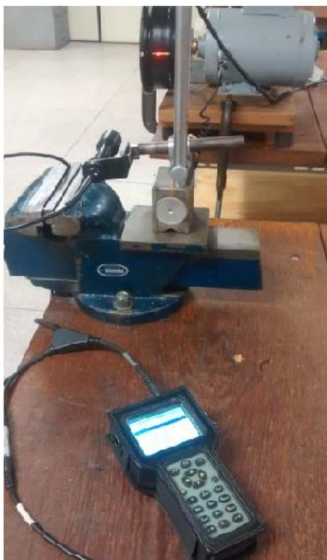
Figura 3.14: Analisador Vibracional e Canhão Laser com Transdutor.
