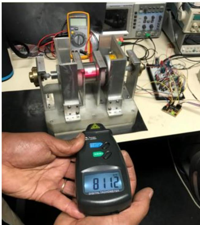
Figura 3.105: Teste Final - Velocidade de 8112 RPM e Tensão de 60 V
