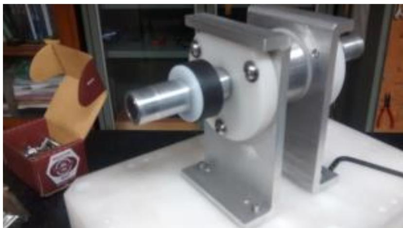
Figura 3.89: Montagem do eixo com rotor nos mancais de levitação (Lenz)
