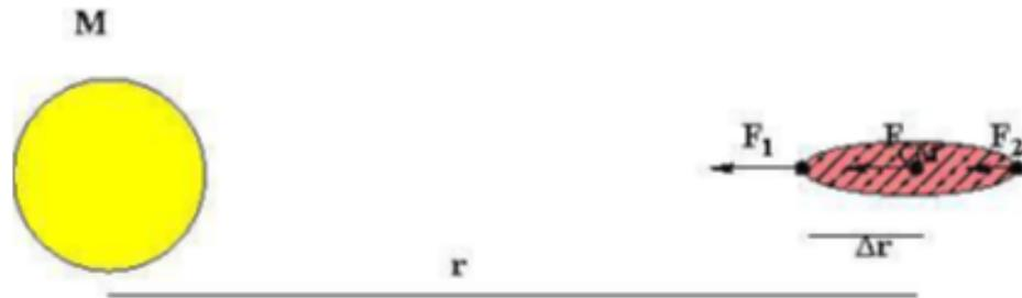
Figura 2.2: Forças gravitacionais em três pontos de um corpo extenso cujo centro de massa está a uma distância “ $r$ ” de outro corpo  $F_1 < F_{CM} < F_2$ .
