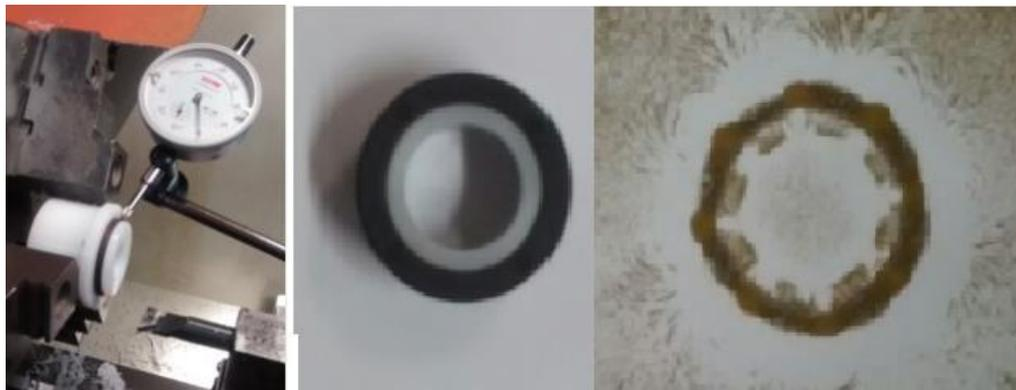
Figura 3.87: Usinagem da bucha do anel ferromagnético e teste com pó ferromagnético (nº de polos)
