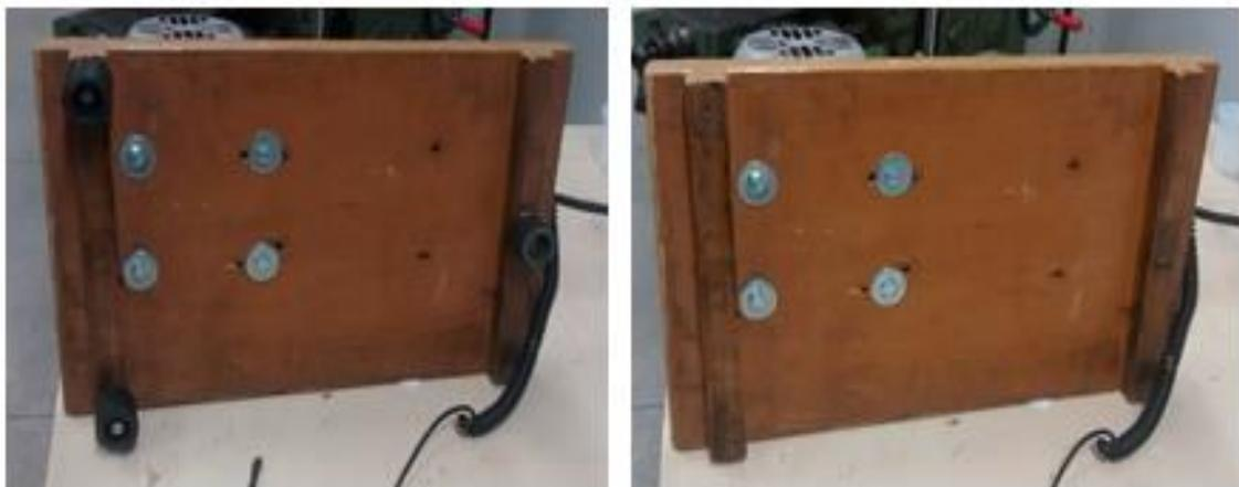
Figura 3.37: Retirada dos vibra-stops do Dispositivo de Campo
