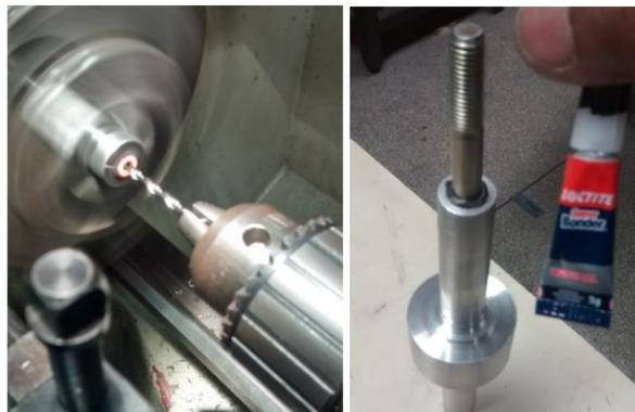
Figura 3.101: Retirada do ímã de neodímio da extremidade ( $T_E$ )
