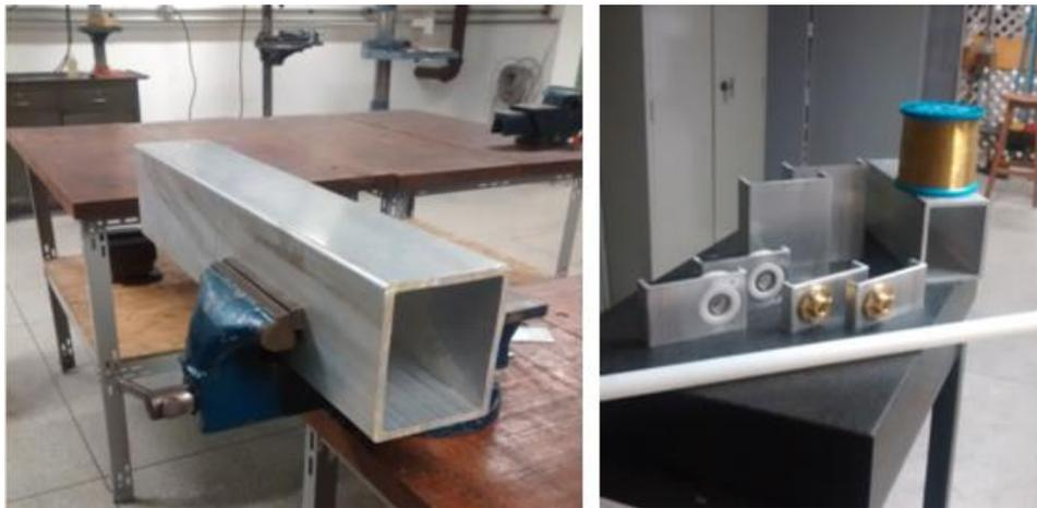
Figura 3.3: Tubo extrudado de alumínio 6061 da Alcoa para confecção dos suportes do PDCG
