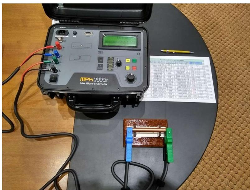
Figura 37. Medição de resistência elétrica.
