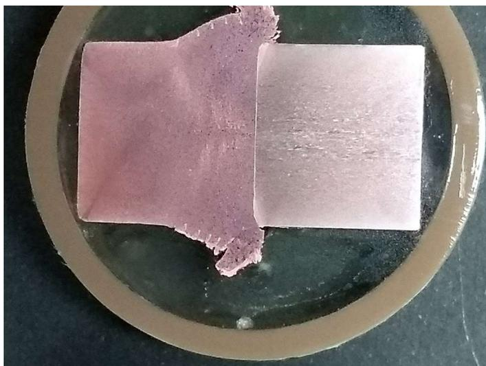
Figura 41. Macrografia de soldagem com junta plana. Amostra nº 43.
