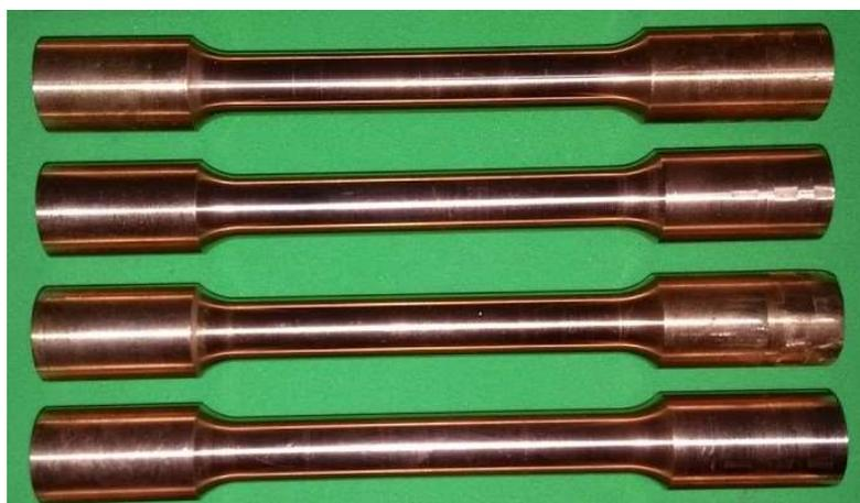
Figura 73. Corpos de prova antes do ensaio de tração
