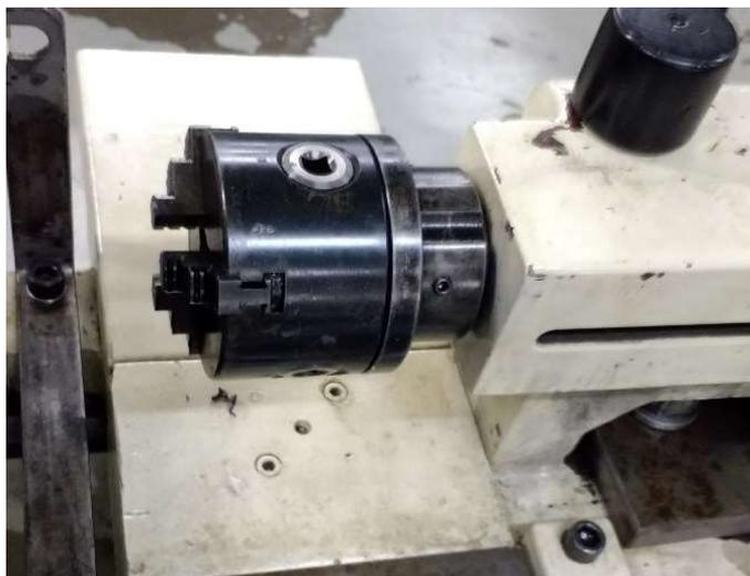
**Figura 21.** Fixação da placa de três castanhas.
