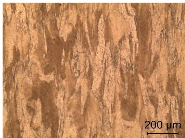
Figura 48. Micrografia do C18150 - ZTA. Aumento de 100 X
