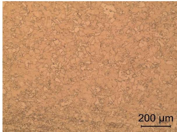
**Figura 60. Micrografia do C11000 - ZTA. Aumento de 100 X**
