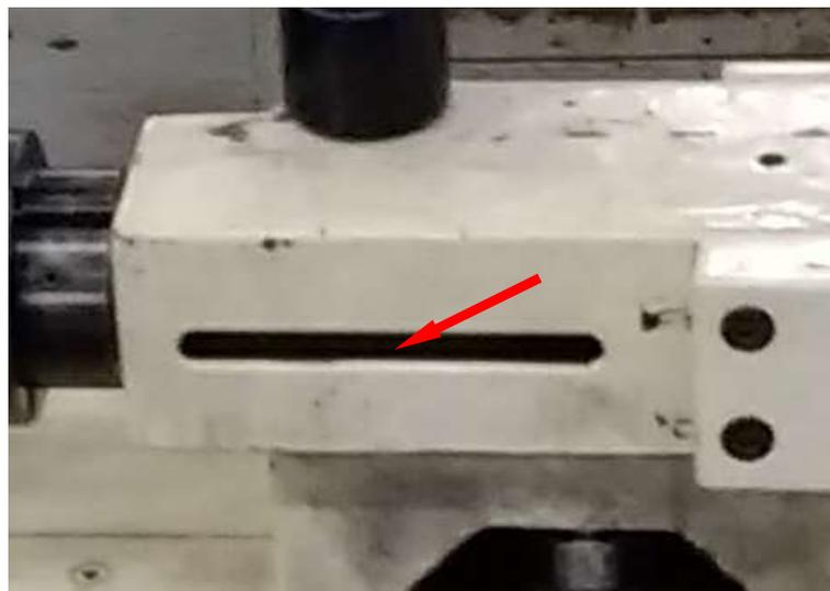
**Figura 25.** Rasgo de passagem para o termopar interno.
