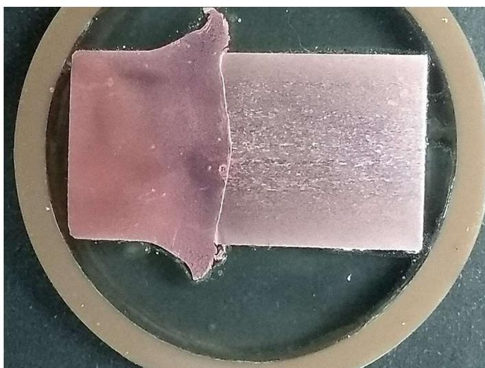
Figura 40. Macrografia de soldagem com junta cônica (160°) Amostra nº 30.
