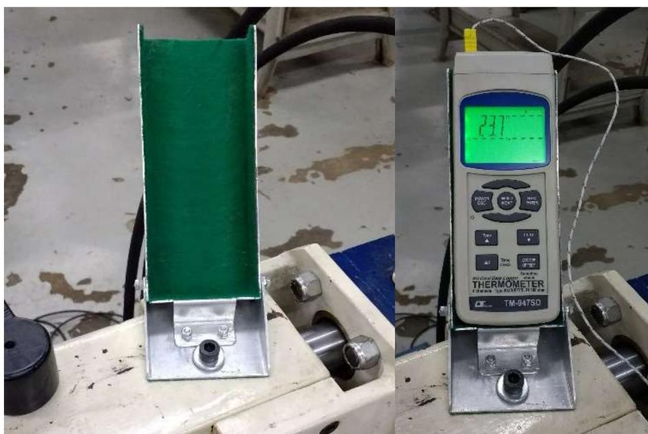
Figura 31. Suporte do termômetro.
