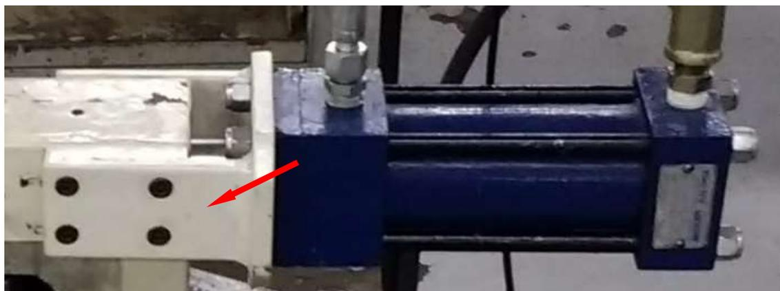
**Figura 22.** Suporte de fixação do cilindro hidráulico.
