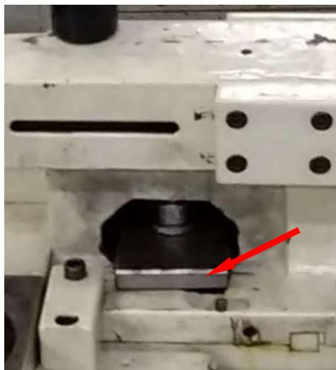
**Figura 23.** Travamento do cabeçote móvel no barramento.
