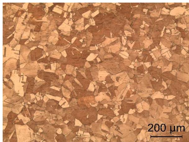
Figura 45. Micrografia do C11000 - ZTA. Aumento de 100 X
