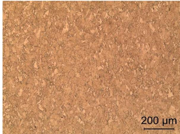
**Figura 57. Micrografia do C11000 - Metal de base. Aumento de 100 X**
