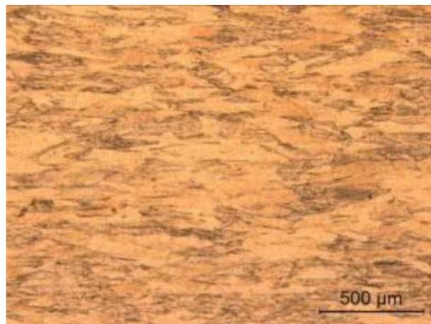
**Figura 12. Micrografia da liga CuCrZr (C18150) – sentido longitudinal. Aumento 50X.**
