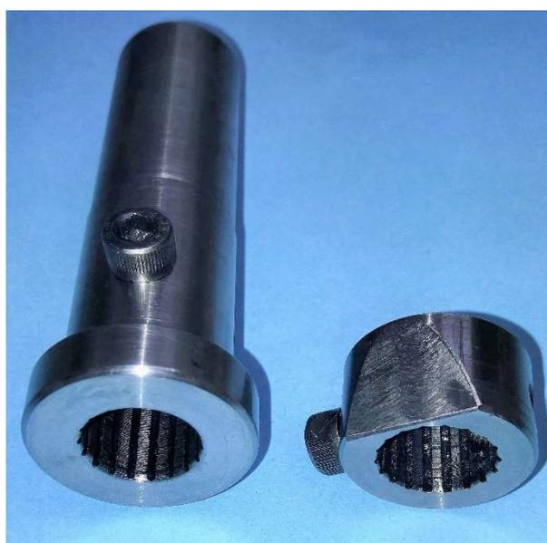
Figura 20. Novas pinças de fixação estriadas internamente (lado rotativo - esquerda e lado fixo - direita).
