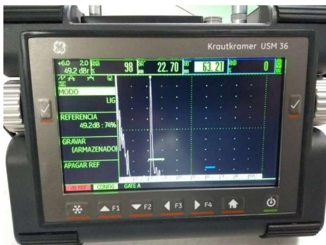
Figura 86. Amplitude do eco de fundo do diâmetro da amostra
