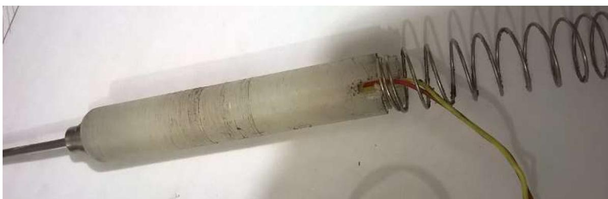
**Figura 26.** Suporte do termopar tipo “K”.
