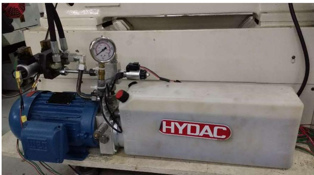
Figura 30. Unidade hidráulica.
