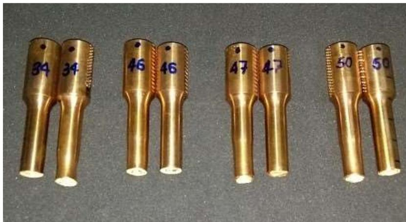
Figura 74. Corpos de prova após o ensaio de tração
