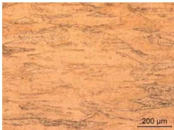
**Figura 13. Micrografia da liga CuCrZr (C18150) – sentido longitudinal. Aumento 100X.**
