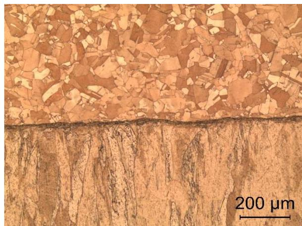
**Figura 53. Micrografia da Região da solda. Aumento de 100 X**
