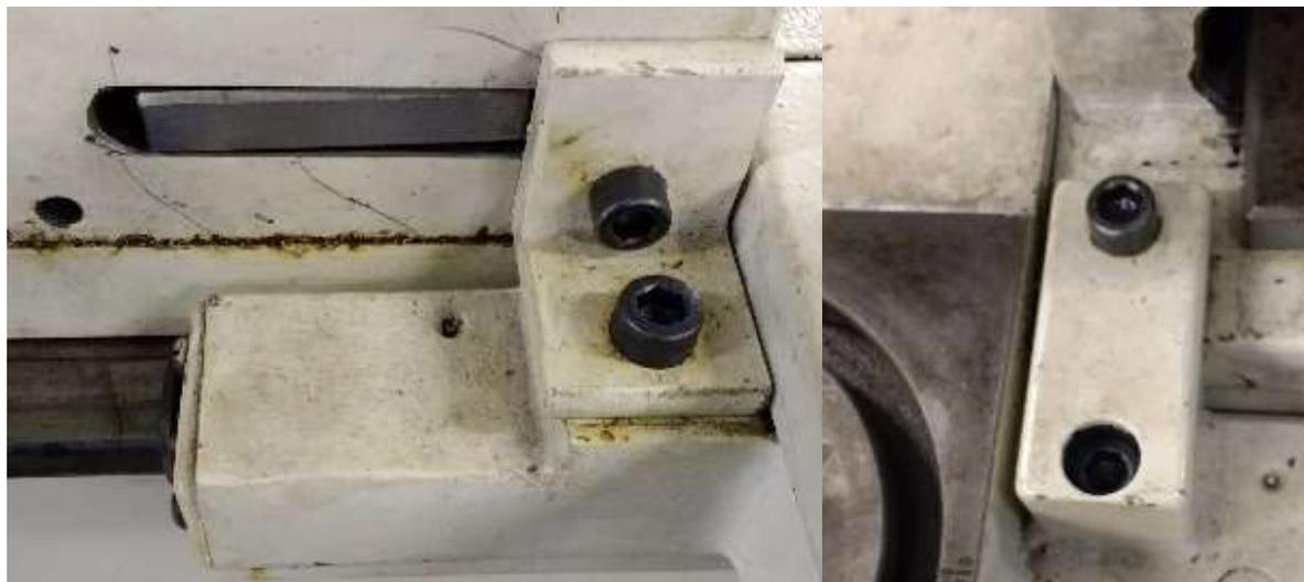
**Figura 27. Acoplamento do cabeçote móvel ao carro principal.**
